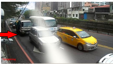
不正改ざん検出後 (グレア)
